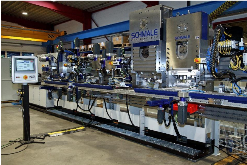
X2000NC, konfiguriert zur Produktion von Sitzstreben (Fotoinweis: Schmale Maschinenbau)
