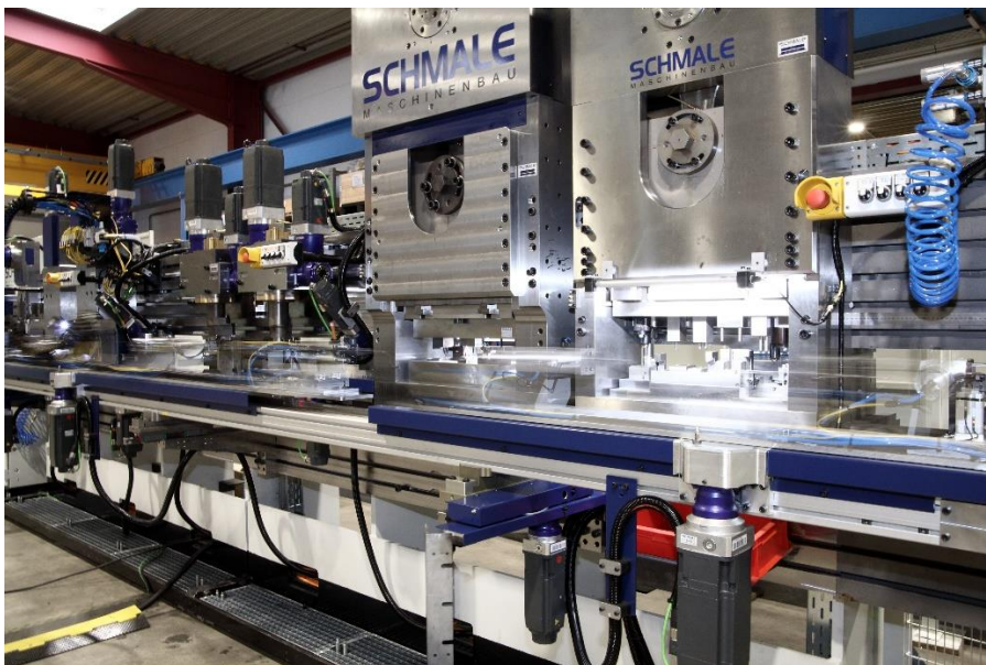
Die X2000NC mit drei Servopressen und zwei Fingerbiegestationen zur Produktion von Sitzstreben im Produktionsbetrieb (Fotoinweis: Schmale Maschinenbau)
