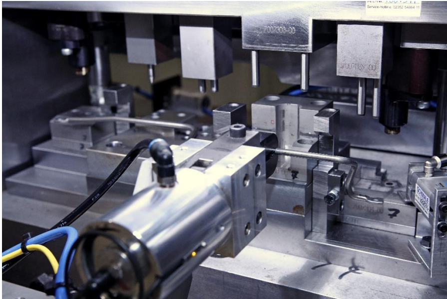
Letzte Umformstation für die Sitzstreben, Stanzpresse (Fotoinweis: Schmale Maschinenbau)
